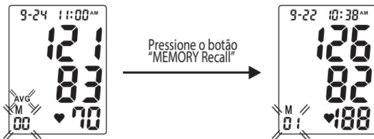
3. Todos os resultados de uma determinada medição serão mostrados, incluindo os resultados da medição, pulsação, indicador de hipertensão, alerta de batimentos irregulares e marca de data e hora.
